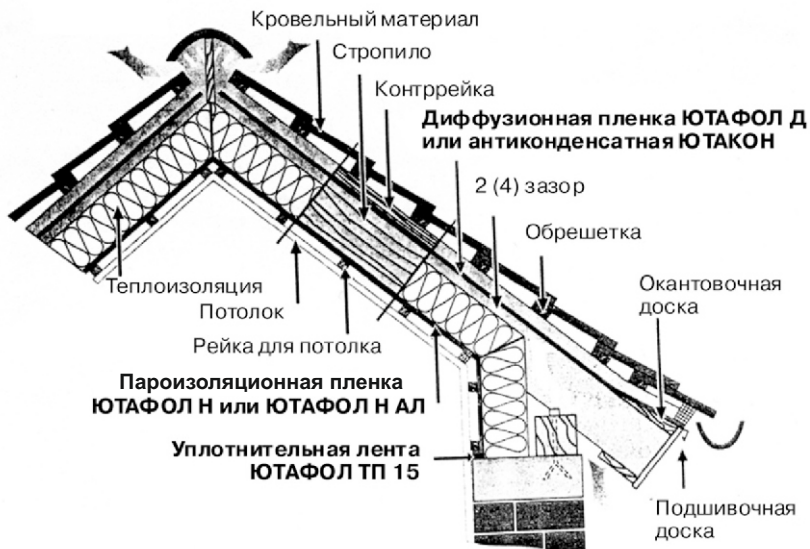
Рис. 6. Кровельная конструкция над отопляемым пространством
